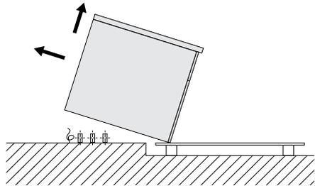
4. 小心地放下设备，然后将其移动到正确位置。最后，拆下运输托盘。
