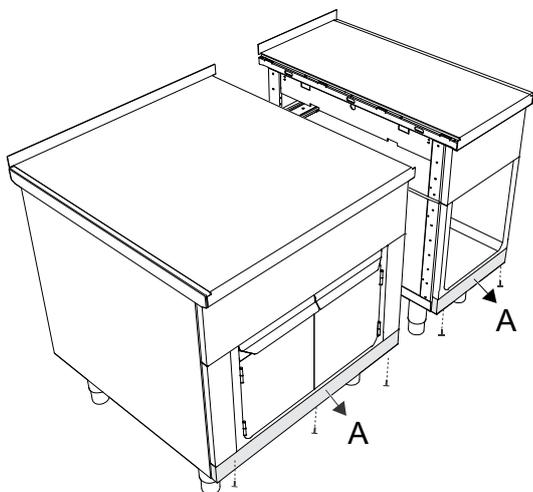
2. 将装置推到一起。使用支脚上的调节螺钉将设备调节至相同高度，然后将它们调平。
