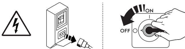
在执行任何安装、组装、清洁或维护程序之前，应把设备断开电源连接。
