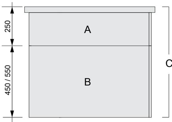
在描述我们的设备时，我们会在顶部模块 **A**、底部模块 **B** 和出厂装配的装置 **C** 之间进行区分。顶部和底部模块可一起或作为单独装置安装。
