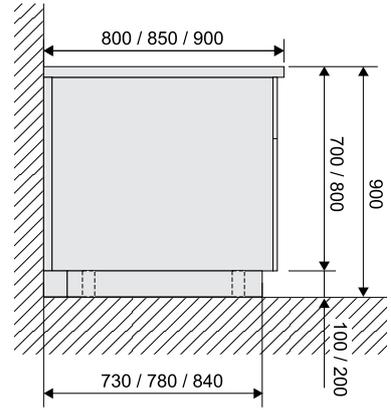
4. 靠墙安装在混凝土底座上
