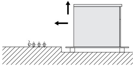
2. 拆下设备底部预先切割好的板。（要进行检修，参见 ）。
