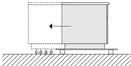
2. 拆下设备底部预先切割好的板。（要进行检修，参见 E 安装图）。
