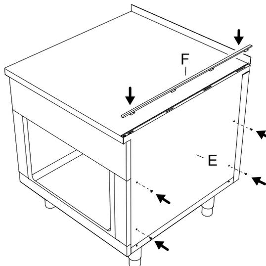
4. Deslice el carril final **F** en el sentido de la flecha para alinearlo en la parte delantera.
