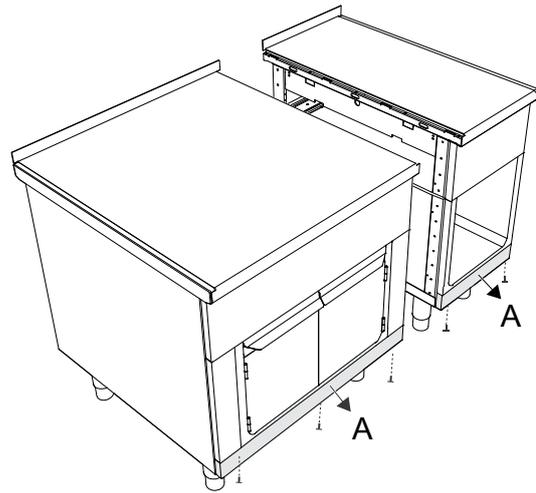
2. Empuje las unidades para unirlos. Utilice los tornillos de ajuste de las patas para situar los aparatos a la misma altura y nivélelos.
