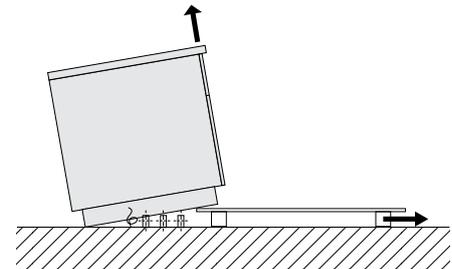
4. Incline el aparato hasta apoyarlo en el suelo. A continuación eleve la parte delantera y retire el palet de transporte.
