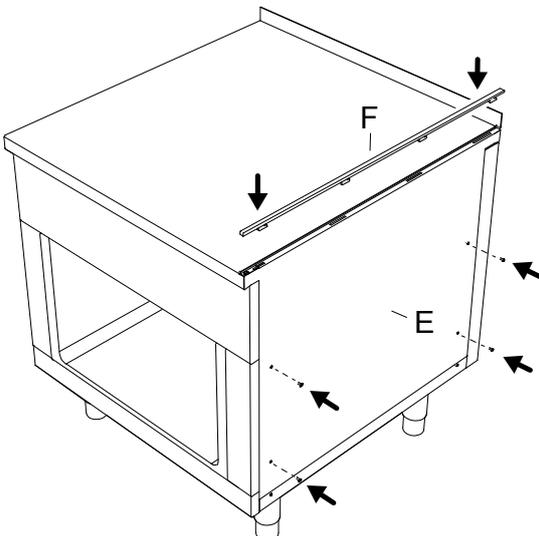
4. Deslice el carril final **F** en el sentido de la flecha para alinearlos en la parte delantera.
