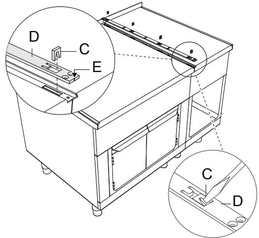
4. Selle toda la longitud de la unión con silicona de larga duración (se recomienda sellado de uniones gris, código: 059611). Fije el carril **D** con los tornillos suministrados **F**. Introduzca el gancho de la parte inferior de la cubierta **G** en los orificios del carril de conexión y deslice la cubierta **G** hacia atrás hasta alinearla con la parte delantera.
