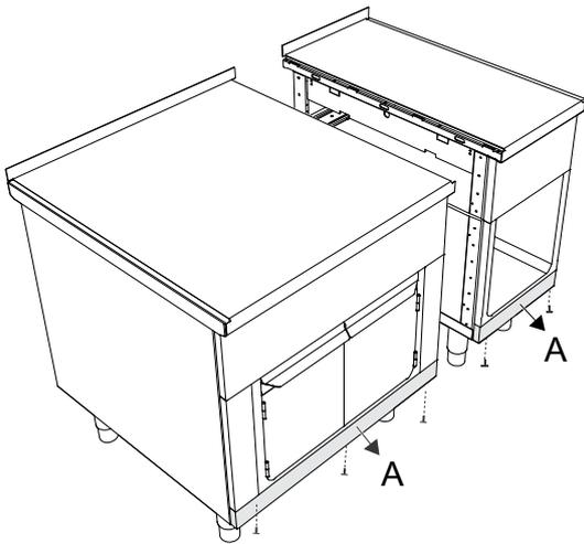
2. Empuje las unidades para unirlos. Utilice los tornillos de ajuste de las patas para situar los aparatos a la misma altura y nivélelos.
