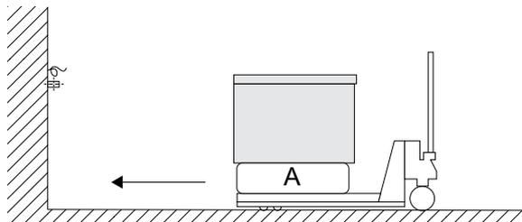
4. Desplace el aparato en la carretilla elevadora hasta la posición preparada en la pared y elévelo a la altura correcta.
