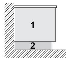
1. Paneles laterales para la instalación en la pared: altura 400/700/800 mm
