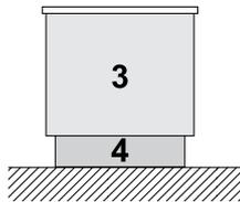
3. Paneles laterales para equipos aislados: altura 700/800 mm
