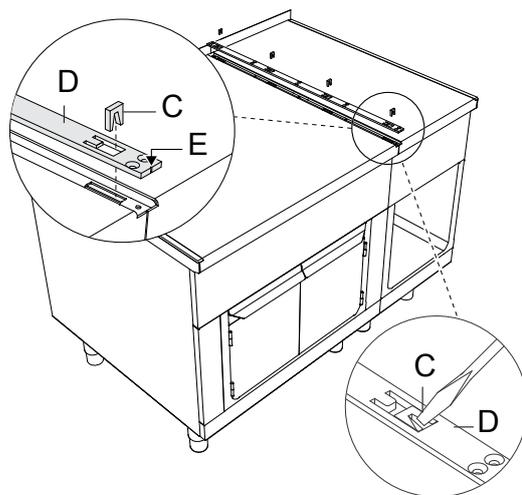
4. Dichten Sie die Verbindung auf ihrer gesamten Länge mit dauerhaltbarer Silikon-Dichtmasse ab (wir empfehlen graue Fugendichtung, Teilnummer: 059611). Befestigen Sie die Schiene **D** mit den mitgelieferten Schrauben **F**. Setzen Sie den Haken unten an der Blende **G** in die Ösen der Verbindungsschiene ein und schieben Sie Blende **G** nach hinten, bis sie mit der Vorderseite bündig ist.
