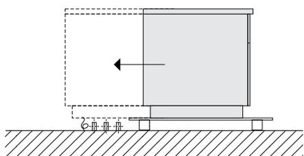
2. Entfernen Sie die vorgestanzte Platte an der Unterseite des Geräts. (Informationen zum Zugang siehe E.3 *Installation und Anschlussdiagramm*.)
