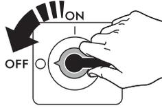
Trennen Sie das Gerät vor Installations-, Montage-, Reinigungs- und Wartungsarbeiten immer erst von der Stromversorgung.
