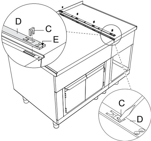
4. Dichten Sie die Verbindung auf ihrer gesamten Länge mit dauerhaltbarer Silikon-Dichtmasse ab (wir empfehlen graue Fugendichtung, Teilenummer: 059611). Befestigen Sie die Schiene **D** mit den mitgelieferten Schrauben **F**. Setzen Sie den Haken unten an der Blende **G** in die Ösen der Verbindungsschiene ein und schieben Sie Blende **G** nach hinten, bis sie mit der Vorderseite bündig ist.
