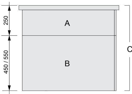
Bei den Gerätebeschreibungen unterscheiden wir zwischen den Aufsatzmodulen **A**, den Grundmodulen **B** und den werkseitig montierten Einheiten **C**. Aufsatz- und Grundmodule können zusammen oder als Einzelgeräte aufgestellt werden.
