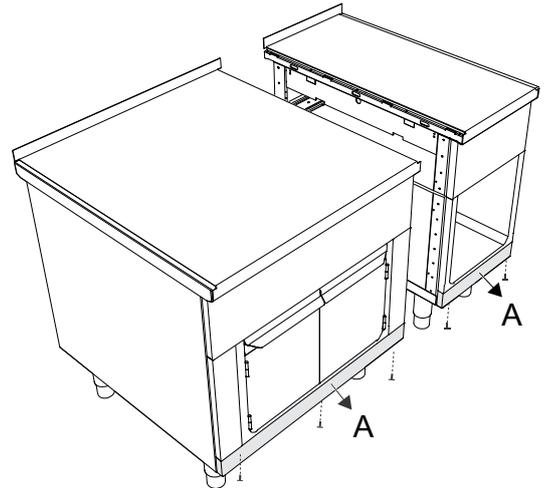
2. Schieben Sie die Geräte aneinander. Bringen Sie die Geräte mit den verstellbaren Füßen auf die gleiche Höhe und richten Sie sie dann waagrecht aus.
