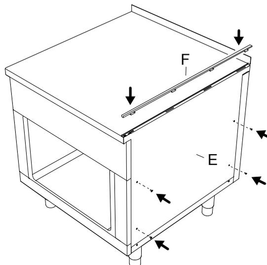
4. Schieben Sie die Abschlusschiene **F** in Pfeilrichtung, bis sie an der Vorderseite bündig anliegt.
