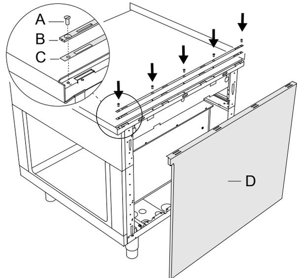
2. Halten Sie die Seitenverkleidung **D** an das Gerät. Setzen Sie die 5 Haken **F** der Verkleidung in die Kerben **E** ein.
