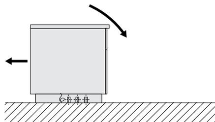
6. Retirer le film de protection extérieure et les protège-arêtes, en veillant à ne pas endommager la surface de l'appareil.
