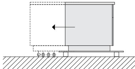
2. Retirer la plaque prédécoupée au bas de l'appareil. (Pour l'accès, voir E.3 Schéma d'installation de raccordement.)
