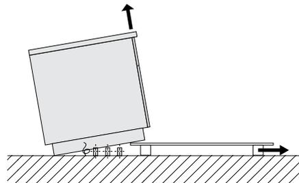
4. Basculer l'appareil jusqu'à ce qu'il soit au sol. Puis lever l'avant et retirer la palette de transport.
