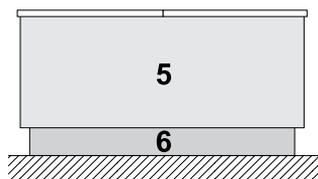
5. Panneaux latéraux pour configuration dos à dos : hauteur 700/800 mm
