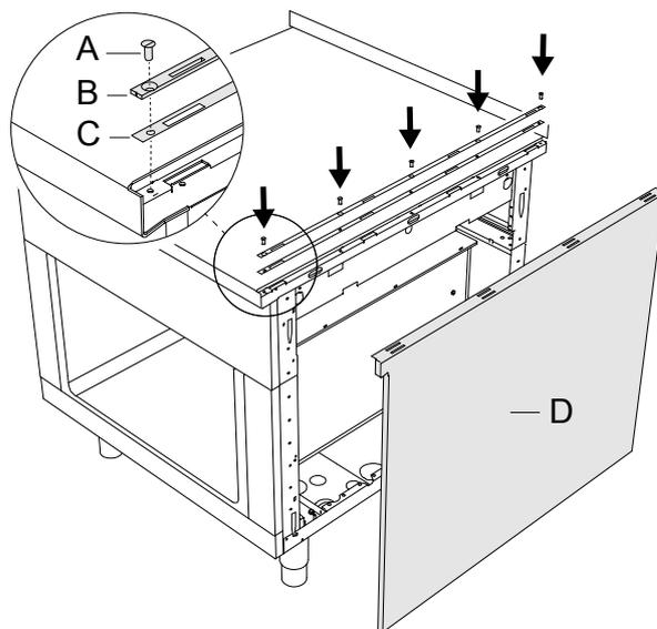
2. Mettre le panneau latéral **D** en place. Placer les 5 crochets du panneau **F** dans les fentes **E**.
