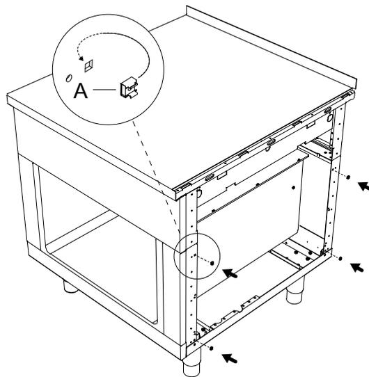
2. Accrocher les glissières de raccordement **C** et **D** à l'aide des vis **B** fournies.
