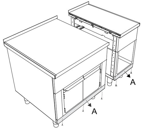
2. Rapprocher les unités. Se servir des vis de réglage des pieds pour mettre les appareils à la même hauteur, puis les mettre de niveau.
