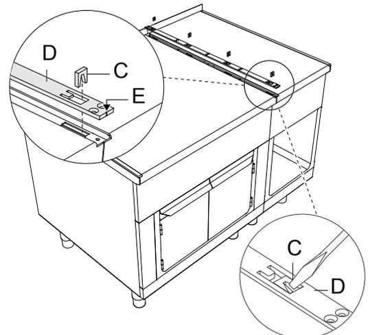
4. Étanchéifier le joint sur toute sa longueur avec un bourrelet de silicone longue durée (il est recommandé d'utiliser le joint d'étanchéité gris, code : 059611). Accrocher la glissière **D** à l'aide des vis **F** fournies. Introduire le crochet de la partie inférieure du couvercle **G** dans les œillets de la glissière de raccordement et reculer le couvercle **G** jusqu'à ce qu'il s'aligne sur l'avant.
