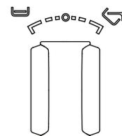
Al momento del rilascio, la manopola ritorna in posizione neutra e l'apparecchiatura rimane nella posizione in cui si trova. Per riportarla in posizione orizzontale, ruotare la manopola in senso antiorario (verso sinistra).
