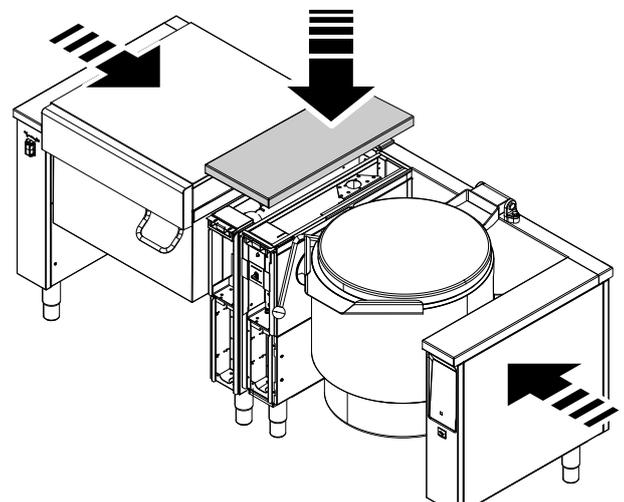
4. Rimontare il pannello dell'interfaccia utente e il pannello frontale fissandoli con delle viti.
