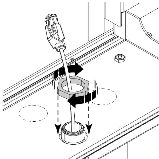
4. Inserire il cavo Ethernet nel connettore montato in fabbrica. Fare riferimento a Fig. 1 *Cavo Ethernet nel connettore*.
