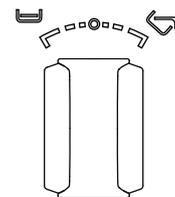
Cuando se suelta el mando, vuelve a la posición neutral intermedia y el equipo se mantiene en la posición de basculación en que se encuentre. Para que recupere la posición horizontal, gire el mando a la izquierda.
