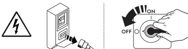
Antes de cualquier procedimiento de instalación, montaje, limpieza o mantenimiento, desenchufe el aparato de la red eléctrica.
