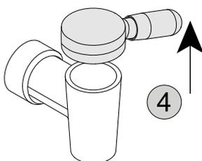
4. Eleve la cubierta del grifo de descarga con el asa.
