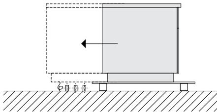
2. Desplace el aparato sobre el palet de transporte de modo que todas las conexiones de instalación queden dentro del aparato.
