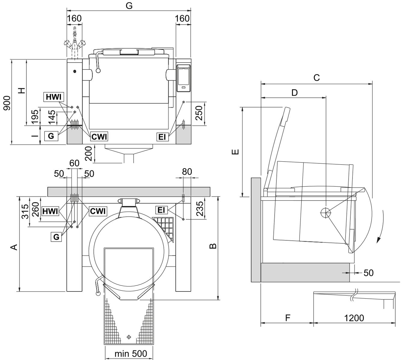
HWI = Conexión de agua caliente
