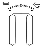
Cuando se suelta el mando, vuelve a la posición neutral intermedia y el equipo se mantiene en la posición de basculación en que se encuentre. Para que recupere la posición horizontal, gire el mando a la izquierda.
