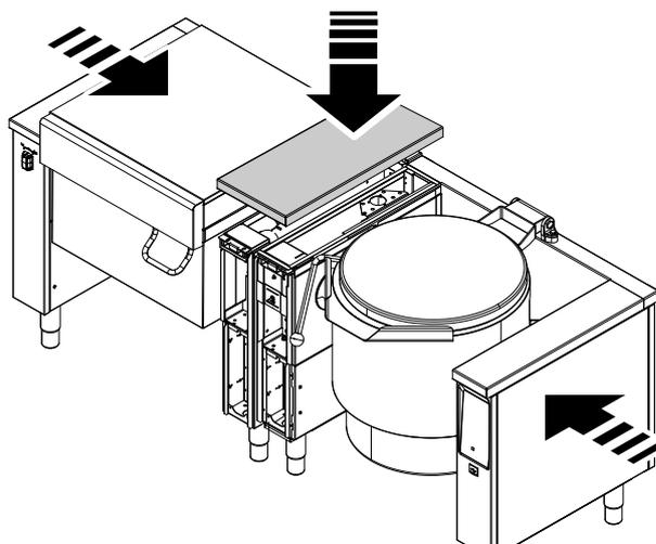
4. Vuelva a montar el panel de interfaz de usuario y el panel frontal, y fíjelos con tornillos.
