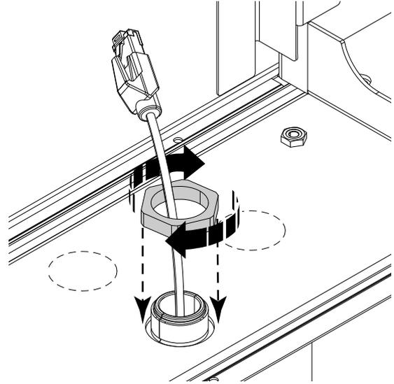
4. Inserte el cable Ethernet en el conector instalado en fábrica, consulte Fig. 1 *Cable Ethernet en el conector*.
