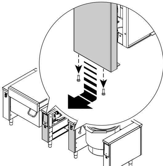
2. Desenrosque los pernos y retire las cubiertas.
