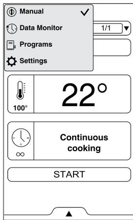
El modo manual permite personalizar los ciclos de cocción con el ajuste de tiempo, temperatura o potencia calorífica (consulte el capítulo L.3.3 *Modo manual*).
