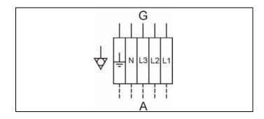
Le branchement au réseau électrique s'effectue au moyen d'un câble prévu par le client, qui dépasse de 1,5 m du sol ou du mur. Les bornes de connexion de l'appareil sont situées derrière, sous le panneau de protection.
