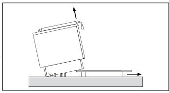
Déposer délicatement l'appareil, le déplacer dans la position définitive souhaitée, le relever à l'horizontale et le fixer.
