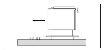
Les branchements qui sortent du sol doivent se trouver le plus près possible de la palette de transport, sur le côté. Déplacer l'appareil sur la palette de transport, de manière à ce que tous les branchements se retrouvent à l'intérieur de l'appareil. Décharger délicatement l'appareil de la palette de transport.
