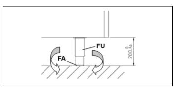
En cas d'utilisation de supports de pied (FA): marquer la position définitive des supports de pied (FA) ou de l'appareil sur le sol, fixer ensuite les supports de pied (FA) en les vissant ou en les collant au sol. Poser l'appareil sur les supports de pied (FA), déterminer et ajuster la hauteur de l'appareil et sa position horizontale à l'aide d'un niveau à bulle en tournant la partie inférieure des pieds (FU).
