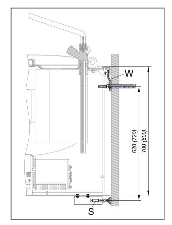
W Plaques de suspension murale S Vis de réglage avec contre-écrou
