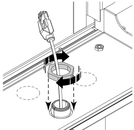
4. Stecken Sie das Ethernet-Kabel in die ab Werk vorgerüstete Steckerbuchse, siehe Bild 1 *Ethernet-Kabel und Steckerbuchse*.
