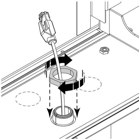
4. Inserte el cable Ethernet en el conector instalado en fábrica, consulte Fig. 1 *Cable Ethernet en el conector*.
