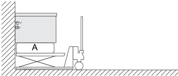
5. Retirer le film de protection extérieure et les protège-arêtes, en veillant à ne pas endommager la surface de l'appareil.
