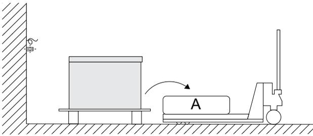
1. Transporter l'appareil sur sa palette de transport et s'arrêter juste devant le point d'installation.
