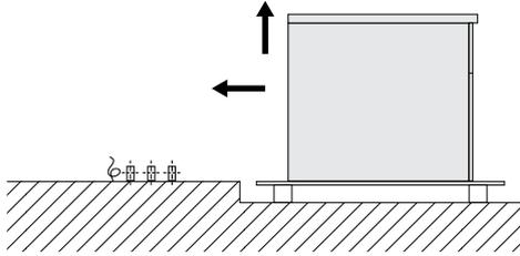
1. Transporter l'appareil sur sa palette de transport et s'arrêter juste devant le point d'installation.
