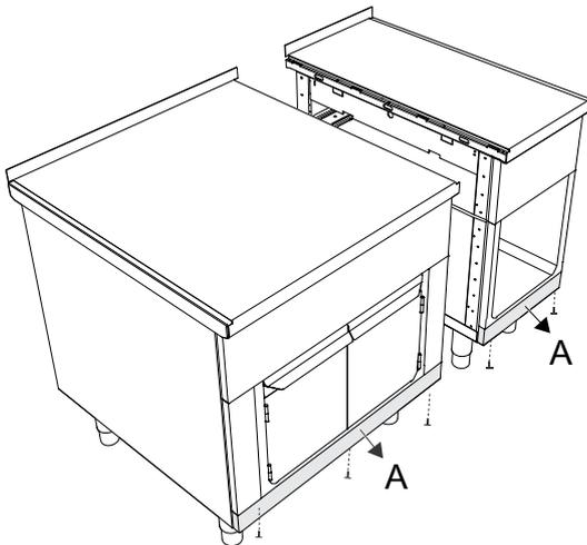
② Rapprocher les unités. Se servir des vis de réglage des pieds pour mettre les appareils à la même hauteur, puis les mettre de niveau.
