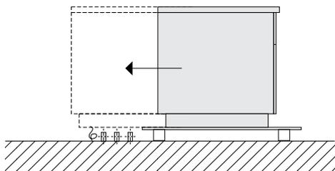
1. Transporter l'appareil sur sa palette et s'arrêter juste devant le point d'installation. Rapprocher la palette de transport autant que possible des raccords qui sortent du sol.
