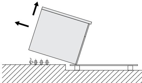
3. Soulever l'unité d'un côté, de manière à ce que tous les raccords d'installation se trouvent à l'intérieur de l'appareil.
