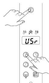
Appuyez deux fois sur le bouton ( - Tableau 2 "Panneau de commande" ) pour accéder aux paramètres de régulation des détergents et des agents de rinçage.
