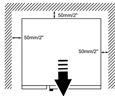
Sur tous les modèles, mais en particulier les modèles à 20 grilles, laisser si possible un espace d'au moins 500 mm entre le côté gauche de l'appareil et les autres surfaces afin de permettre les opérations de maintenance.
