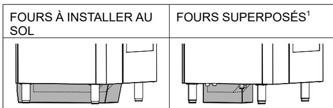
1. L'utilisation d'un rehausseur peut remplacer le couvercle, sauf sur les installations 6 grilles sur 10 grilles, pour lesquelles ce couvercle est obligatoire.
