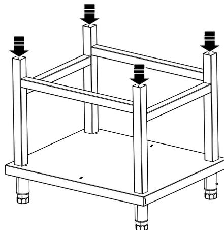
2. Poser l'appareil sur le support de four en introduisant les pieds de positionnement dans les montants tubulaires.
