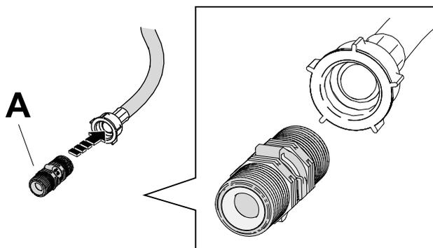
3. Brancher les doubles clapets anti-retour A – insérés dans les flexibles d'eau – aux robinets d'eau.
