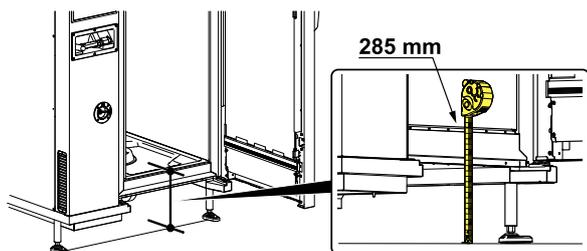
5. Après avoir réglé les pieds avant du four à 285 mm, mettre le four de niveau en réglant correctement les pieds arrière.
