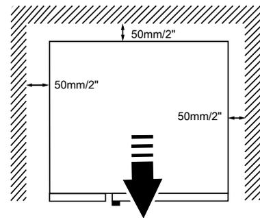
Pour tous les modèles, et particulièrement pour ceux à 20 grilles, prévoir dans la mesure du possible au moins 500 mm entre le côté gauche de l'appareil et une autre surface pour faciliter les opérations de maintenance.
