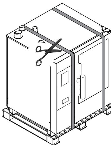
3. Soulever l'appareil à l'aide d'un chariot élévateur, retirer la palette et poser l'appareil à l'endroit choisi ;
