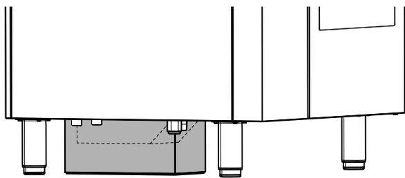
1. L'utilisation d'un rehausseur peut remplacer le couvercle, sauf sur les installations 6 grilles sur 10 grilles, pour lesquelles ce couvercle est obligatoire.
