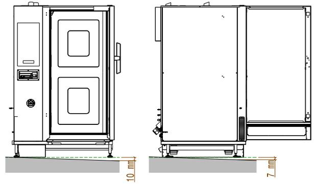
2. Si la déclivité du sol est supérieure aux limites, il est obligatoire d'installer la "Rampe de mise à niveau".
