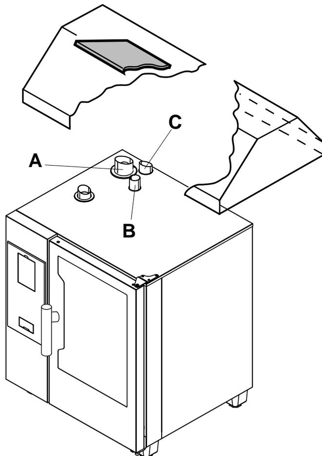
A Évacuation du gaz du générateur de vapeur (modèles au gaz avec boiler)
