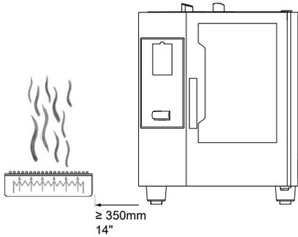
S'il n'est pas possible de maintenir une distance suffisante entre le côté gauche de l'appareil et les sources de chaleur, une protection thermique peut être prévue pour réduire les charges thermique (voir le catalogue des accessoires).
