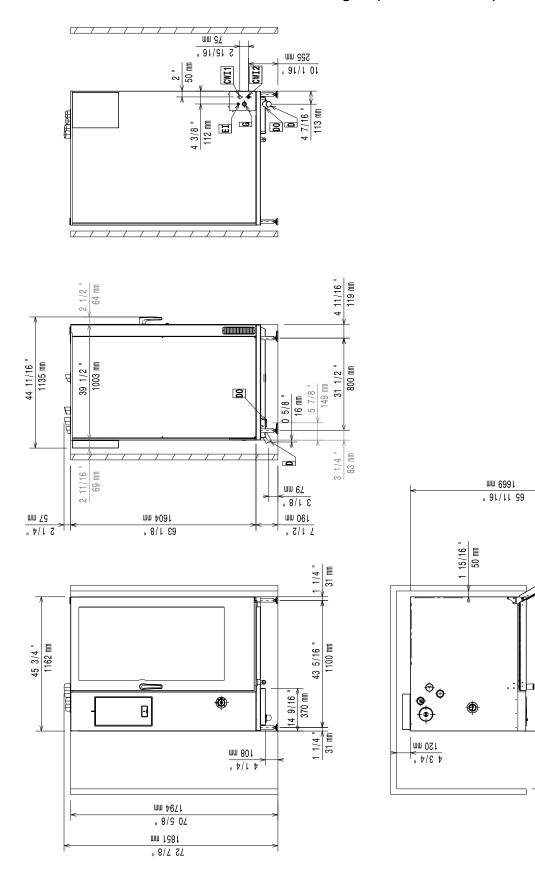
D = Drain outlet ∞50 mm M EI = Electricity inlet CW1 = Cold water inlet G 3/4"  $\label{eq:cw2} \begin{array}{l} \mathsf{CW2} = \mathsf{Cold} \text{ water inlet G } 3/4" \text{ for treated water ISO } 228/1 \\ \mathsf{G} = \mathsf{Gas} \text{ connection } \$1"\mathsf{M} \ (20 \ \mathsf{GN} \ 1/1 - 2/1 \ \mathsf{and} \ 10 \ \mathsf{GN} \ 2/1) \\ \mathsf{G} = \mathsf{Gas} \text{ connection } \$1/2"\mathsf{M} \ (6 \ \mathsf{GN} \ 1/1 - 2/1 \ \mathsf{and} \ 10 \ \mathsf{GN} \ 1/1 \ ) \end{array}$
