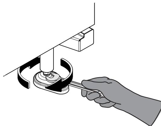
4. Den Abstand zwischen Garraum und Fußboden messen. Die Messung zuerst in der Mitte ausführen und dann prüfen, ob die linke Seite und die rechte Seite innerhalb eines Toleranzbereichs von  $\pm 2,5$  mm liegen. Der Abstand muss  $285 \pm 2,5$  mm betragen.
