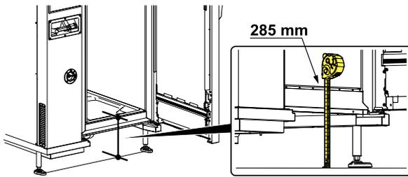
5. Nach der Einstellung der vorderen Stützfüße des Ofens auf 285 mm muss der Ofen korrekt mit den **hinteren** Stützfüßen nivelliert werden.
