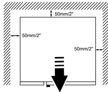
Bei allen Modellen, und speziell bei Modellen mit 20 Einschüben, sollte ein Mindestabstand von mindestens 500 mm zwischen der linken Seite des Geräts und sonstigen Flächen eingehalten werden, um einen problemlosen Wartungszugang zu ermöglichen.
