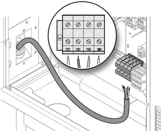
7. Danach das Kabel mit dem Kabelverschraubungsring sichern.
