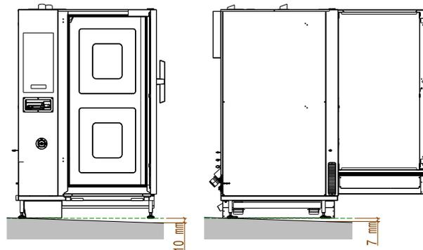
2. Falls das Gefälle des Fußbodens über den Grenzwerten liegt, ist die "Nivellierunterlage" zwingend vorgeschrieben.
