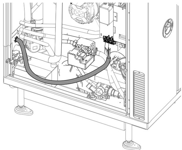
6. Danach das Kabel mit dem Kabelverschraubungsring sichern.
