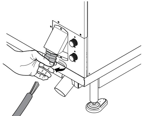
4. Ein Stück Kabelmantel entfernen, sodass die Leitungen freiliegen.
