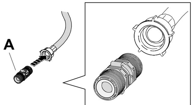
3. Die in die Wasserschläuche eingesetzten Doppelrückschlagventile A an die Wasserhähne anschließen.
