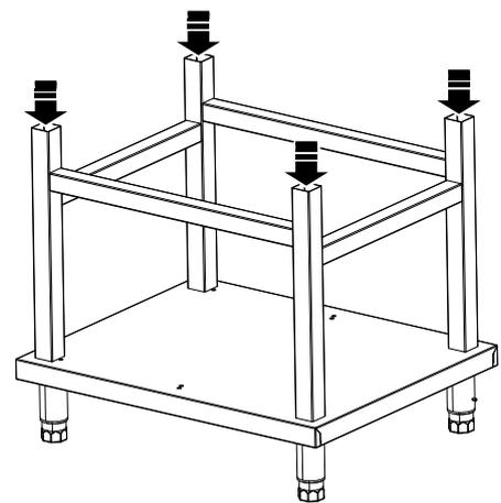
2. Das Gerät auf dem Untergestell platzieren und darauf achten, dass die Stützfüße in den senkrechten Aufnahmen sitzen.
