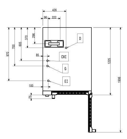
GAS Model 20 GN 1/1 - Installation diagram (597405W00)
