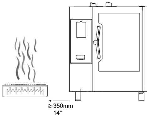
Si no es posible mantener el lado izquierdo del aparato a una distancia suficiente de las fuentes de calor, un escudo térmico puede reducir las cargas térmicas (consulte el catálogo de accesorios).
