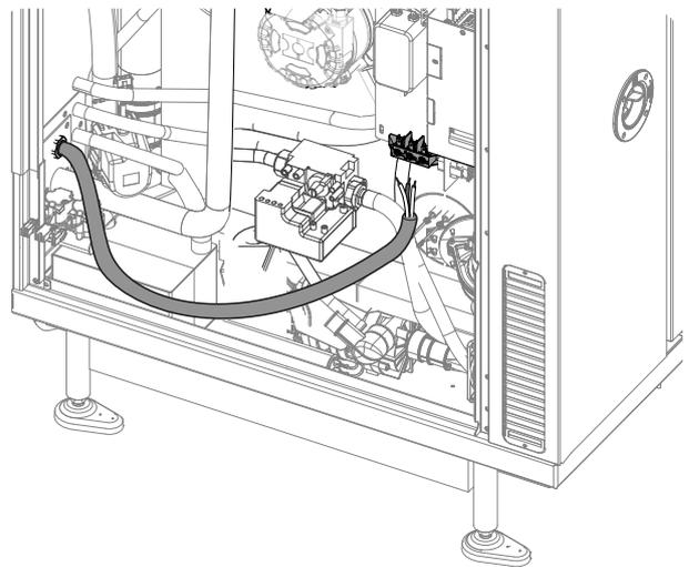
6. Después de la conexión fije el cable atornillando el anillo pasacables.
