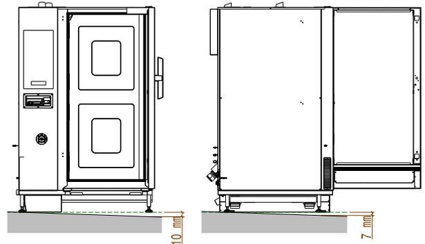
2. Si la inclinación del suelo supera los límites, es obligatorio utilizar la "Leveling Ramp" (rampa de nivelación).
