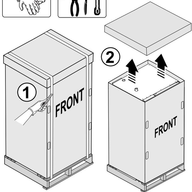
3. Retire las esquinas superiores de cartón, la protección del asa y los 4 cartones que envuelven el equipo.
