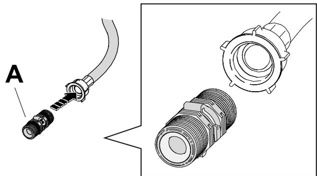
3. Conecte las válvulas de seguridad doble A, introducidas en las mangueras de agua, a los grifos.
