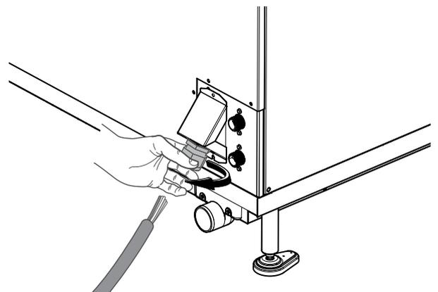
4. Retire la funda de todos los hilos del cable;
