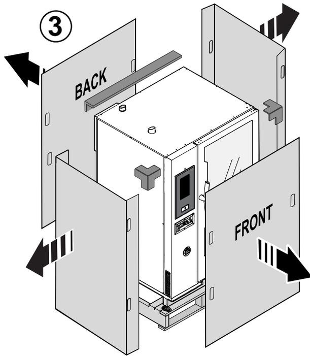
4. Con una carretilla elevadora, retire el palet y coloque el equipo donde se utilizará.
