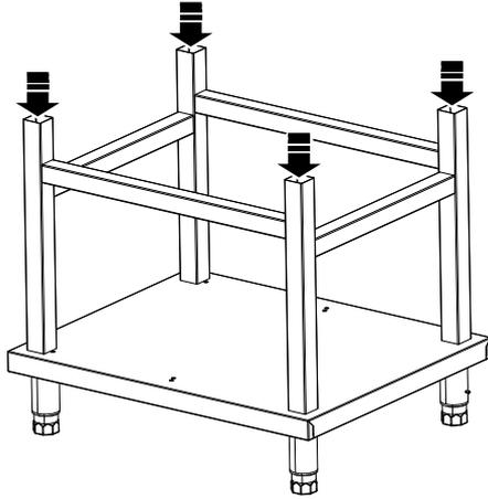
2. Utilizando el equipo de elevación adecuado, coloque el equipo sobre el soporte del horno insertando las patas de fijación en los montantes tubulares.
