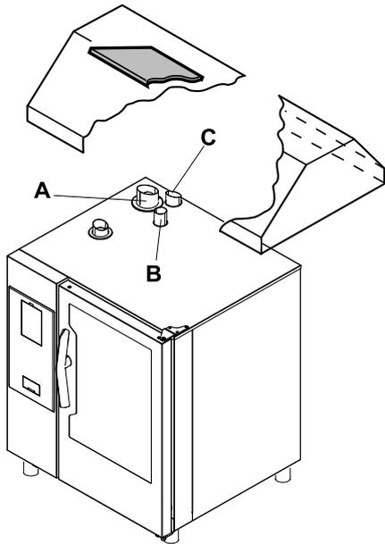
**A** Gas de escape procedente del generador de vapor (modelos de gas con gas con caldera)
