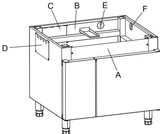
2. Sustituya las patas del horno por las patas especiales suministradas con el armario.
