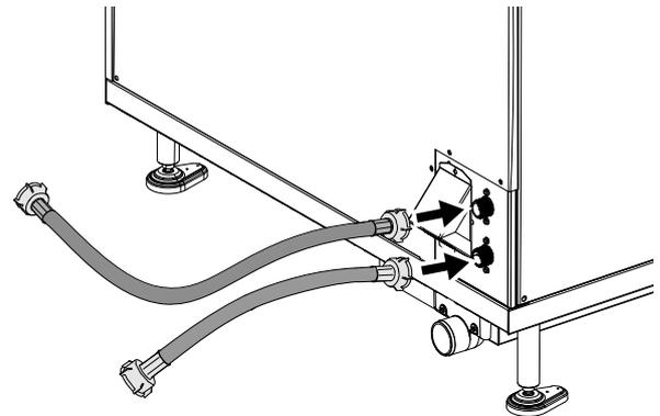
2. Introduzca las válvulas de seguridad doble A, suministradas con el equipo, en el otro extremo de las mangueras de agua. Asegúrese de introducirlas en la posición y dirección correctas.
