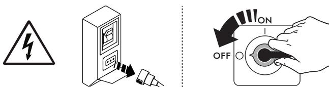
Togliere l'alimentazione all'apparecchiatura prima di procedere a qualsiasi procedura di installazione, montaggio, pulizia o manutenzione.
