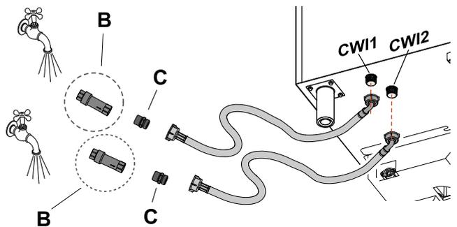
B dispositivo di prevenzione del riflusso (in dotazione)
