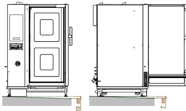
2. Nel caso in cui la pendenza del pavimento sia superiore al limite consentito, l'uso della "Rampa di livellamento" è obbligatorio.
