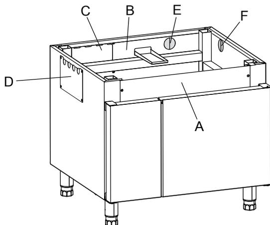
2. Sostituire i piedini del forno con gli appositi piedini forniti con l'accessorio credenza;
