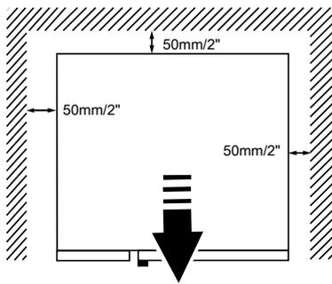
Con tutti i modelli, ma in particolare con quelli a 20 griglie, quando è possibile, lasciare uno spazio di almeno 500 mm tra il fianco sinistro dell'apparecchiatura e le altre superfici per consentire le operazioni di manutenzione.
