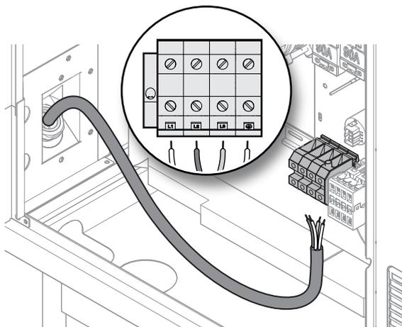
7. Dopo aver effettuato il collegamento, fissare il cavo avvitando l'anello del pressacavo.
