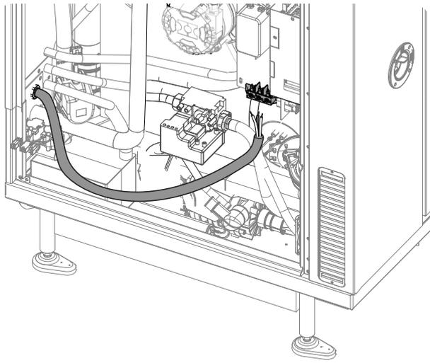
6. Dopo aver effettuato il collegamento, fissare il cavo avvitando l'anello del pressacavo.
