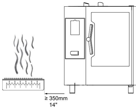
Se non è possibile mantenere il fianco sx dell'apparecchiatura a una distanza sufficiente dalle fonti di calore, una protezione termica può ridurre i carichi termici (vedere catalogo accessori).
