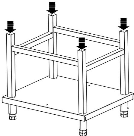
2. Con l'ausilio di attrezzatura di sollevamento idonea, posizionare l'apparecchiatura sul cavalletto per forno inserendo i piedini di posizionamento nei tubolari verticali.
