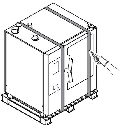
3. Sollevare l'apparecchiatura con un carrello elevatore, togliere il pallet e posizionarla nel luogo di utilizzo.
