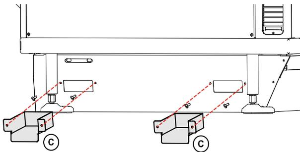
L'esecuzione del montaggio a tenuta stagna secondo la procedura sopra descritta impedirà che liquidi eventualmente fuoriusciti sul pavimento adiacente si infiltrino sotto le parti non accessibili dell'apparecchiatura.
