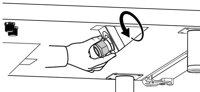
Tipo di fermacavo per 380-415 V 3N~ o 3~, 400-430 V 3N~, 440 V 3~ e 480 V 3~
