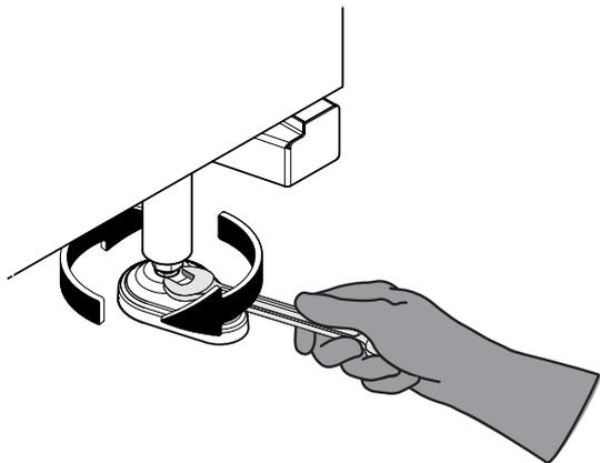
4. Misurare l'altezza dalla cella al pavimento. Effettuare la misurazione al centro dell'apparecchiatura, quindi controllare che il fianco sinistro e il fianco destro rispettino la tolleranza di  $\pm 2,5$  mm. Vedere la figura in basso.
