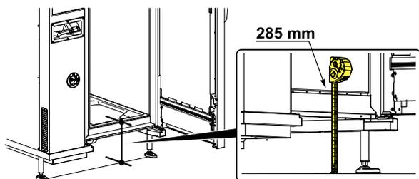
5. Dopo aver posizionato i piedini anteriori del forno a 285 mm, è necessario livellare il forno procedendo alla regolazione di quelli **posteriori**.
