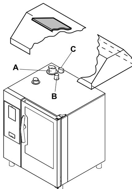
A Gas di scarico dal generatore di vapore (modelli a gas con boiler)
