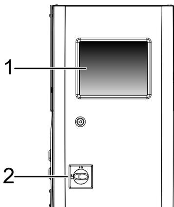
1 Écran tactile avec sélection directe des fonctions. Effleurer les icônes sélectionnées pour activer les fonctions correspondantes.
