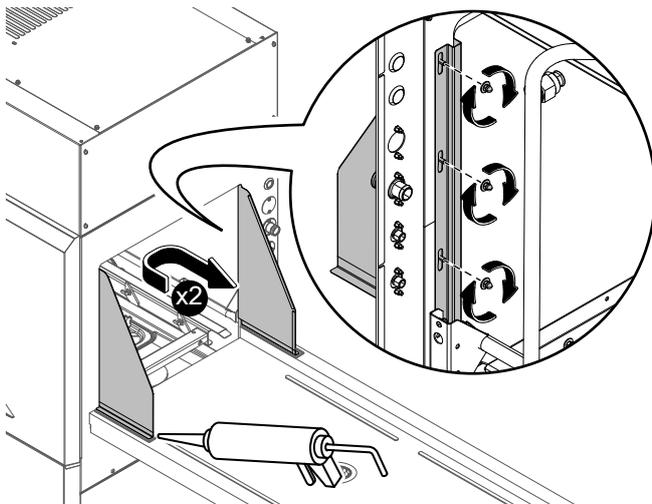
**E.12 Instalación del interruptor de fin de carrera**
