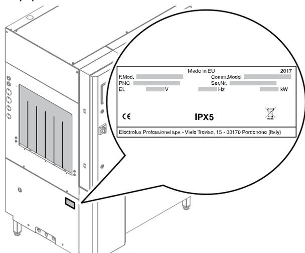
Fig. 1 Posición de la placa de datos
