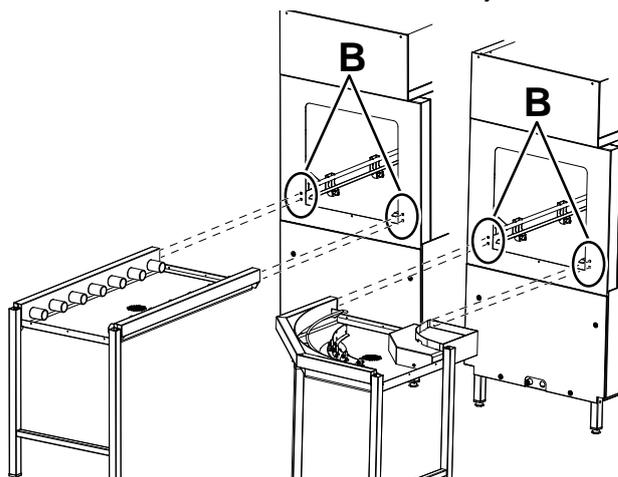
3. Regule el aparato girando las patas correspondientes y compruebe que quede perfectamente nivelado.
