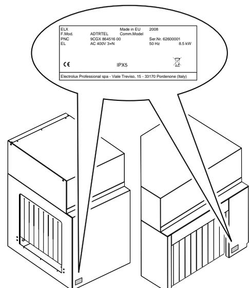
Fig. 1 Posición de la placa de datos
