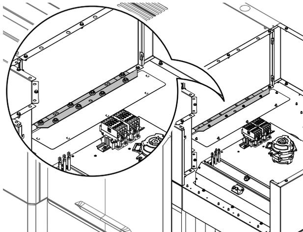
8. Fije la abertura del módulo de secado a los soportes laterales. Fije con firmeza los soportes con los tornillos (5 x 14 mm).
