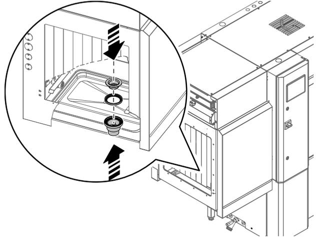
7. Conecte la salida del desagüe del secador y de la máquina con la manguera de conexión suministrada.
