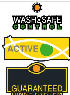
En los modelos con **Active/Wash Safe Control**, un dispositivo especial comprueba la temperatura de la fase de aclarado. El sistema de aclarado garantizado [GRS, GUARANTEED RINSE SYSTEM] controla automáticamente tiempo y temperatura del aclarado.
