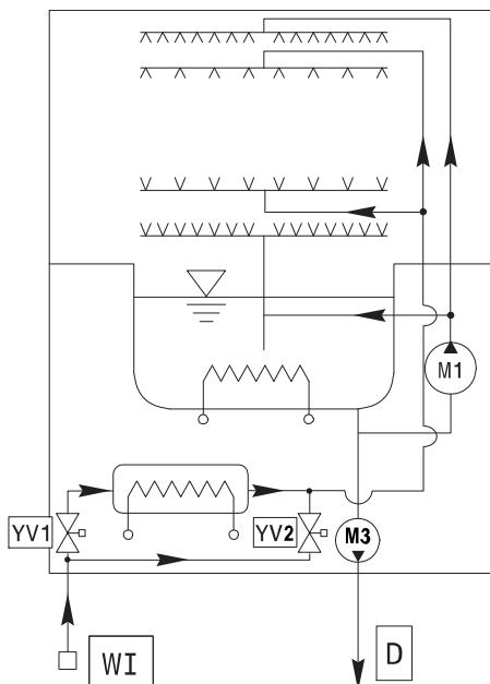
Přístroj s přívodem tlakové vody – s cyklem oplachování studenou vodou ale bez vypouštěcího čerpadla
