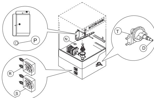
K dispozici je hotový otisk "N", který má být proděravěn ( $\varnothing$  8 mm) pro umístění snímače pro měření koncentrace čisticího prostředku.
