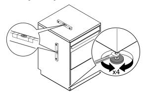
Für die Installation der Geschirrspülmaschine unter einer Arbeitsplatte ist ein Einbauraum mit Abmessungen laut folgender Abbildung erforderlich. Die Geschirrspülmaschine aufstellen und durch Drehen der höhenverstellbaren Füße gerade ausrichten.
