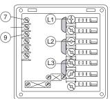
Den Klarspülmitteldosierer an die Klemmen 8 und 9 anschließen. Diese Anschlusspunkte führen beim Füllen des Tanks und am Ende des Klarspülgangs für eine festgelegte Zeit Spannung (siehe Abschnitt I.2 Einstellen der Dosierer).
