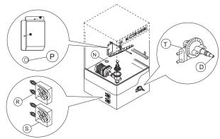
Zur Installation des Sensors für die Spülmittelkonzentration ist werkseitig eine Sollbruchstelle "N" ( $\varrho$  8 mm) vorgesehen.
