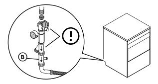
Im Leitungsabschnitt zwischen Gerät und Hauswasserleitung messen, ob der dynamische Wasserzulaufdruck für Maschinen mit Druckboiler zwischen 2 bar [200 kPa] und 3 bar [300 kPa] und für Maschinen mit atmosphärischem Boiler zwischen 0.5 bar [50 kPa] und 7 bar [700 kPa] liegt (die Messung vornehmen, während der Tank der Geschirrspülmaschine oder der Boiler mit Wasser gefüllt werden).
