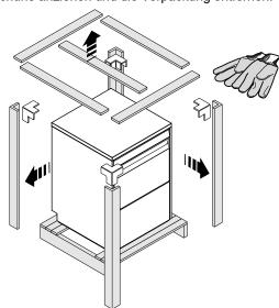
Das Gerät mit einem Gabelstapler anheben, die Unterlage entfernen und es am Bestimmungsort aufstellen.
