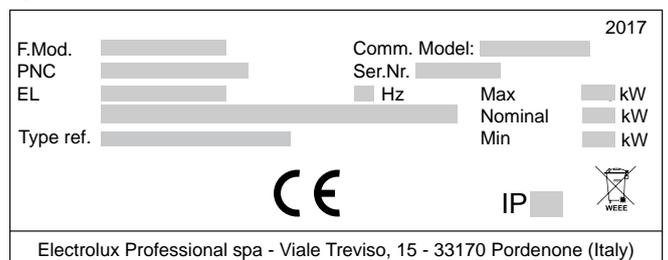
Das Typenschild enthält die technischen Gerätekenndaten. Im Folgenden wird die Bedeutung der verschiedenen aufgeführten Daten erläutert.
