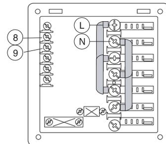
Den **Klarspülmitteldosierer** zwischen den Klemmen 8 und 9 anschließen. Diese Anschlusspunkte führen beim Füllen des Tanks und am Ende des Klarspülgangs für eine festgelegte Zeit Spannung (siehe Abschnitt H.2 *Einstellen der Dosierer*).
