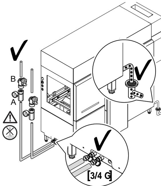
Fig. 3 Collegamento idraulico per la macchina lato sinistro
