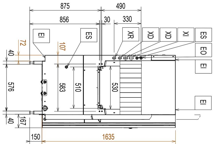
D = Uscita di scarico  $\varnothing = 50$  mm (esterno)
