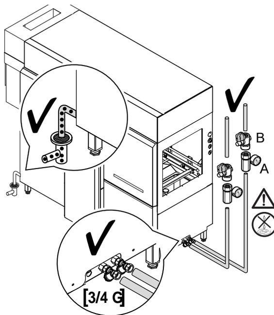
Fig. 4 Collegamento idraulico per la macchina lato destro
