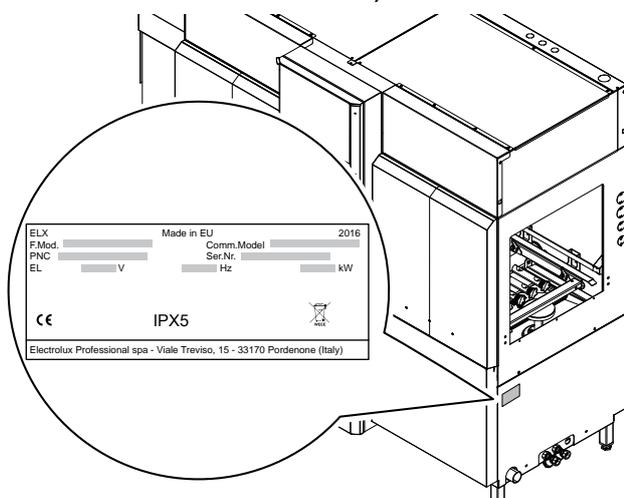
**Fig. 2 Posizione targhetta caratteristiche (lato sinistro macchina)**
