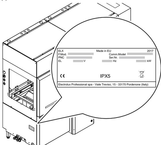
**Fig. 1 Posizione targhetta caratteristiche (lato destro macchina)**
