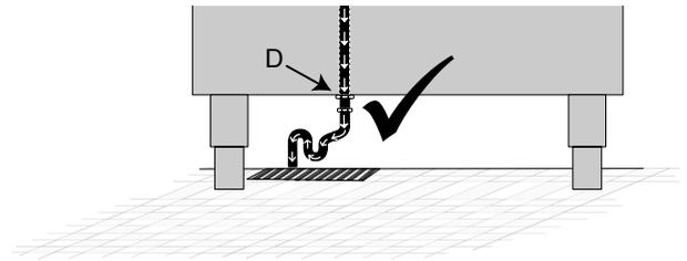
Der Durchmesser der Ablauföffnung beträgt 1 1/2", daher sollte eine 1 1/2"-Ablaufleitung oder ein Schlauch mit Durchmesser 25 mm verwendet werden.
