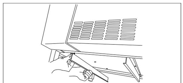
7. Die Wanne aus der Kühlzelle entnehmen und in die Führungsschienen einschieben.
