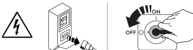
Trennen Sie das Gerät vor Installations-, Montage-, Reinigungs- und Wartungsarbeiten immer erst von der Stromversorgung.
