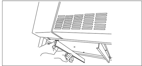
7. Die Wanne aus der Kühlzelle entnehmen und in die Führungsschienen einschieben.
