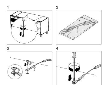
Fije el cable a la pared con un taco para asegurar el aparato de manera permanente.
