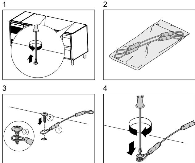
Fixer ensuite le câble au mur à l'aide d'une cheville de sorte à immobiliser l'appareil ;
