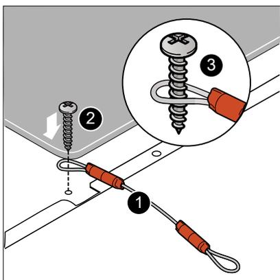
4. fixer à nouveau la vis avec le câble sur le dessus de l'appareil :
