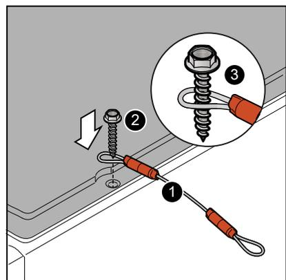
3. fixer à nouveau la vis avec le câble sur le dessus de l'appareil.
