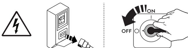
Avant toute procédure d'installation, de montage, de nettoyage ou d'entretien, couper l'alimentation électrique de l'appareil.
