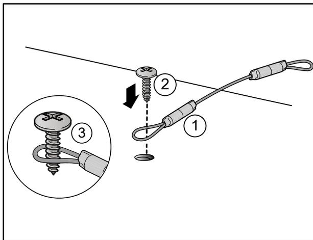
4. fissare nuovamente la vite completa del cavetto sul cielo dell'apparecchiatura;
