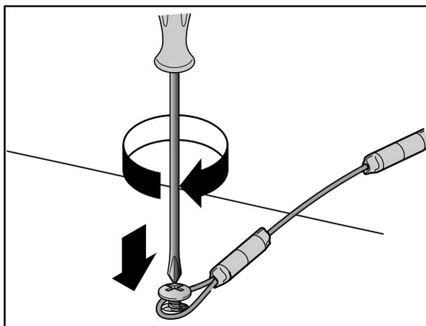
5. il cavetto, infine, va fissato al muro usando un tassello, così da assicurare definitivamente l'apparecchiatura;
