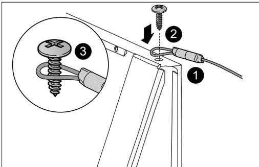
4. Drehen Sie die Schraube mit der Kabelschleife wieder in die Geräteabdeckung hinein.
