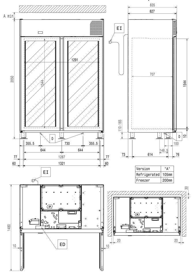
ED = Allacciamenti elettrici EI = Lunghezza del cavo di alimentazione D = Piletta di scarico della cella RI = Ingresso refrigerante (liquido) RO = Uscita refrigerante (gas)
