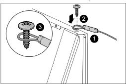
fissare nuovamente la vite completa del cavetto sul cielo dell'apparecchiatura;
