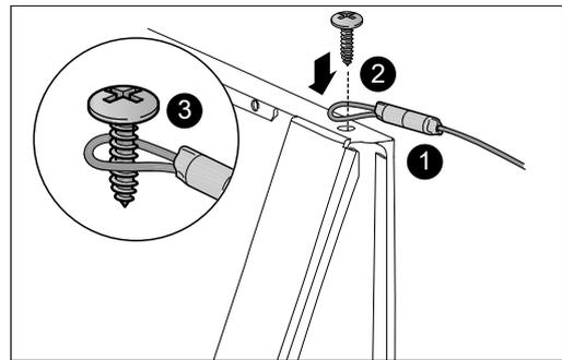
4. resserrer la vis avec le câble sur le dessus de l'appareil ;
