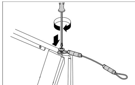
5. fixer ensuite le câble au mur à l'aide d'une cheville de sorte à immobiliser l'appareil ;
