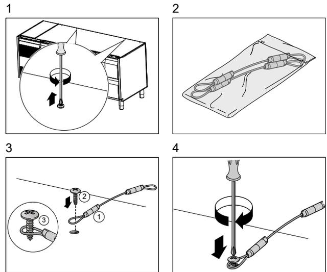
Il cavetto, infine, va fissato al muro usando un tassello, così da assicurare definitivamente l'apparecchiatura;
