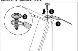
4. Drehen Sie die Schraube mit der Kabelschlaufe wieder in die Geräteabdeckung hinein.
