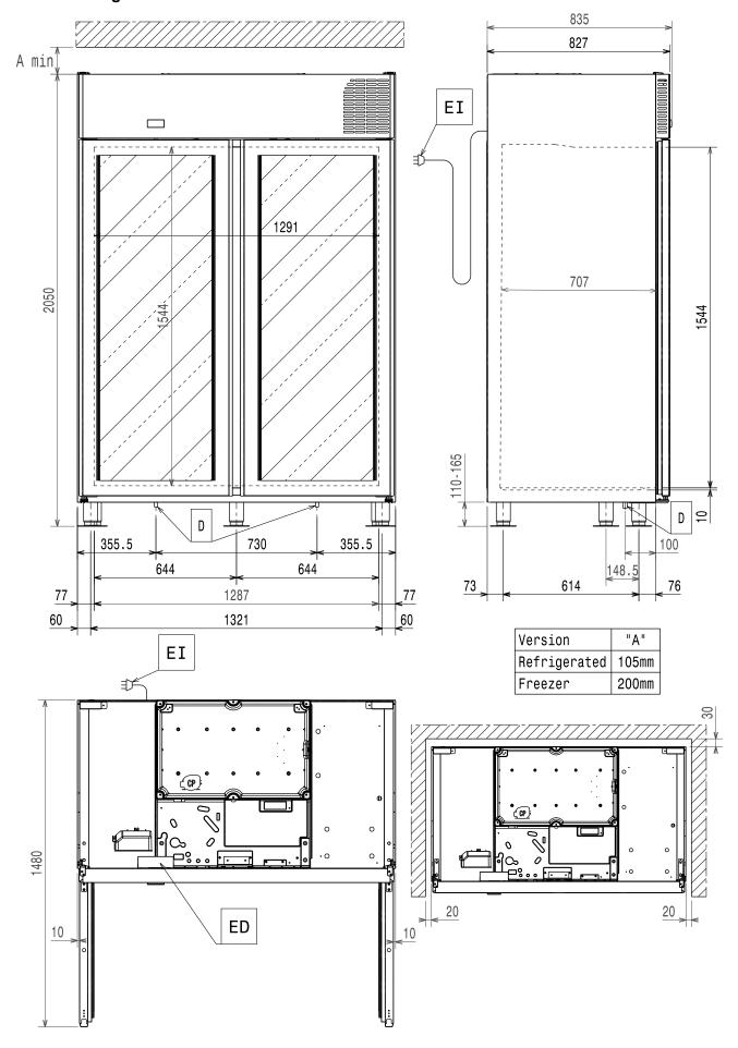
ED = Elektrische Anschlüsse EI = Netzkabellänge
