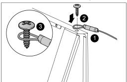
fissare nuovamente la vite completa del cavetto sul cielo dell'apparecchiatura;
