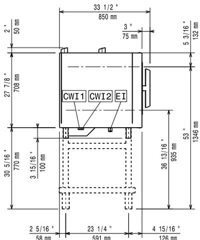
CWI1 = Napojení studené vody 1      EI = Elektrické napojení
