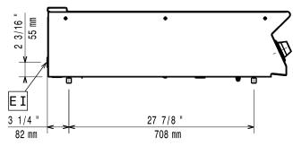
Electrical inlet (power) Equipotential screw
