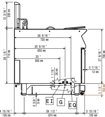
EI = Conexión eléctrica (energía)
