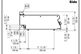
**EI** = Electrical inlet (power) **EQ** = Equipotential screw
