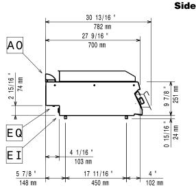
El = Electrical inlet (power) **EQ** = Equipotential screw
