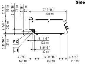
El = Electrical inlet (power) EQ = Equipotential screw
