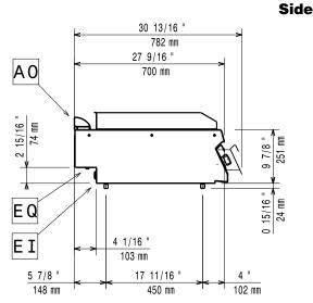
El = Electrical inlet (power) EQ = Equipotential screw
