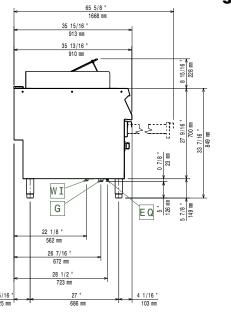
El = Electrical inlet (power) = Equipotential screw
